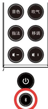
开机状态下长按蓝牙按键开启/关闭蓝牙，可连接时蓝牙按键灯慢速闪烁
