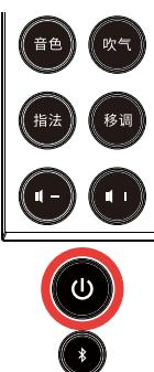
关机状态下，按住“音色”键，然后长按电源键开机，屏幕闪烁“rs”数次即可恢复出厂设置。
