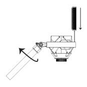
2.将麦克风放置在防震支架,带logo一方为正面,防震支架下面旋钮可扭紧固定
